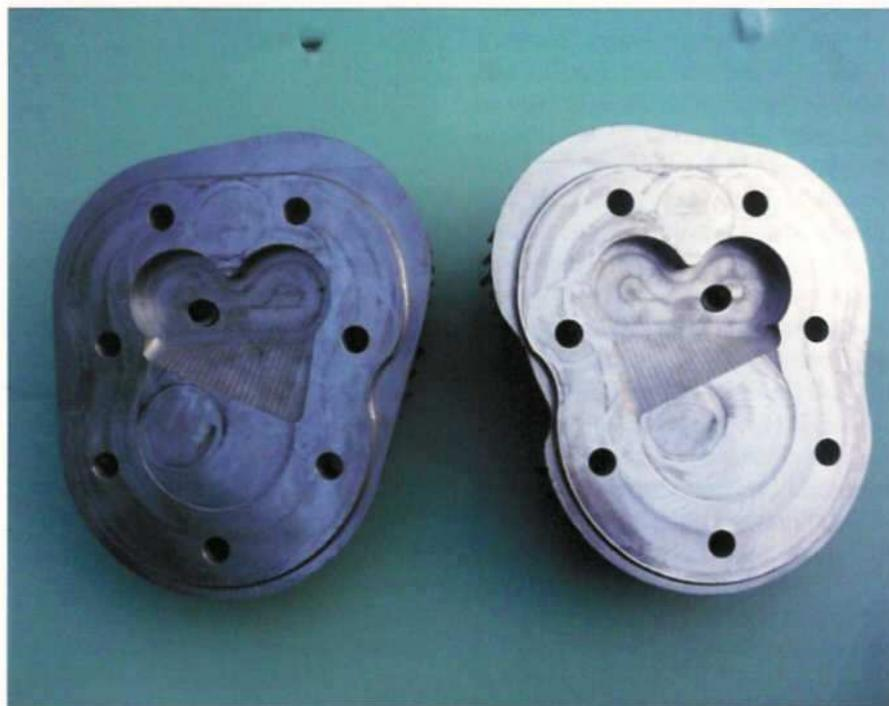
Materialverdichtung geHIPt (im Ofen auf knapp unter dem Schmelzpunkt erhitzt und 500 bar Druck ausgesetzt). Anschließend hat Peter Brunner Tage und Nächte an der Fräsmaschine ver-
